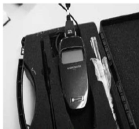
風速計はリースを利用して毎朝チェック。 作業中止の基準は風速10m/秒
